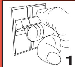
Desconecte la energía en el Breaker Principal antes de instalar el Toma protector.
