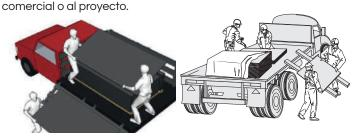
Manipular las láminas siempre de canto, evitando deflexiones en posición horizontal
