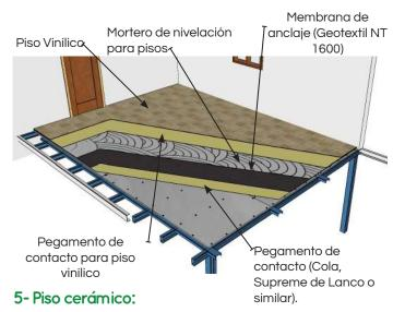
La aplicación de una loseta cerámica o porcelanato requiere de tratamiento de la junta y de la superficie de la base de Plycem. Para esto se debe usar una membrana de anclaje con geotextil del tipo NT 1600 (no tejido), el más delgado, la cual servirá de interface entre el fibrocemento y la loseta cerámica y evitará que cualquier esfuerzo o movimiento horizontal en la base, genere alguna fractura en la cerámica.
