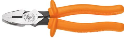
Estas pinzas de corte lateral tipo New England con aislamiento tienen aislamiento de doble capa y cumplen con las normas IEC 60900 y ASTM F1505. Están fabricadas con acero forjado con cuchillas templadas por inducción para ofrecer resistencia y durabilidad. Tienen un diseño de alta palanca que proporciona 46 % más potencia de corte y agarre que otros diseños de pinzas.
