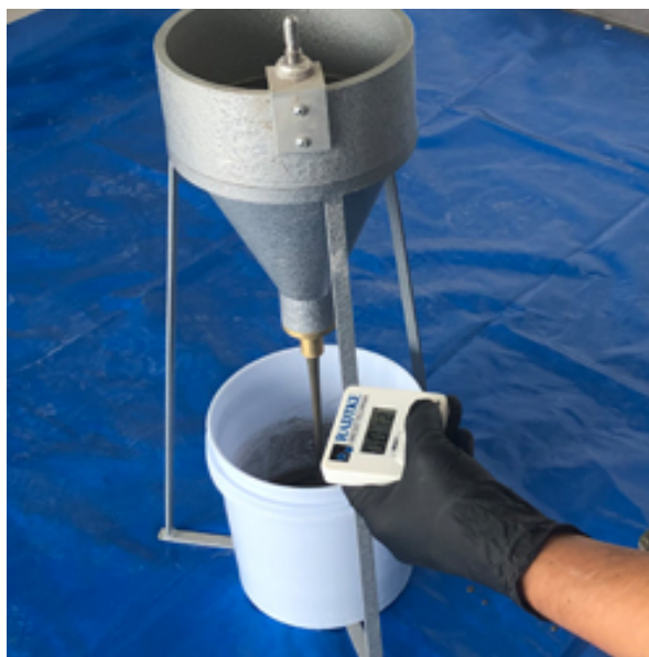
Prueba de fluidez en cono (ASTM C939)
