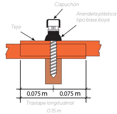
**Nota:** En lugares con condiciones frecuentes de vientos y/o lluvias fuertes, se debe instalar con traslape transversal de 2 ondas.
