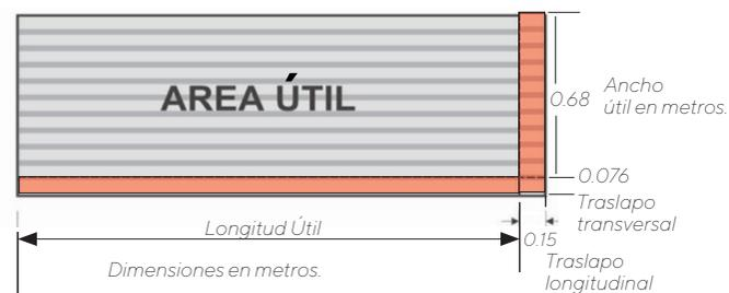
**Nota:** Siempre realice la perforación de las láminas en la cresta y no en el valle, utilice broca con un diámetro mayor al del elemento de fijación (1/8" mayor), nunca perforo con puntilla.
