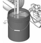
5. Gire la válvula de seguridad para arriba. Si sospecha que la boquilla o el tubo flexible estuvieran obstruidos o que la presión no fuera completamente liberada; LENTAMENTE desapriete la tuerca de retención del protector de la boquilla o la tuerca de retención de la manguera para libertar la presión. En seguida, desapriete completamente
