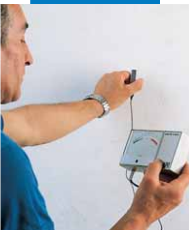
Comprobación de la humedad del yeso
