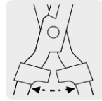
Topes de nylon, mayor resistencia al impacto
